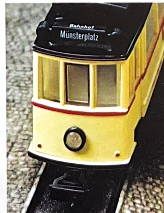
Geschlossene Plattformen, große rahmenlos eingesetzte Fenster, freistehende Zielschilder. Federnder Scherenbügel, 2-Achs-Antrieb, gogTram Kupplung an beiden Enden, Länge über Rahmen 94 mm.
